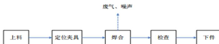
图4-1 焊装车间1工艺流程及产排污节点图
