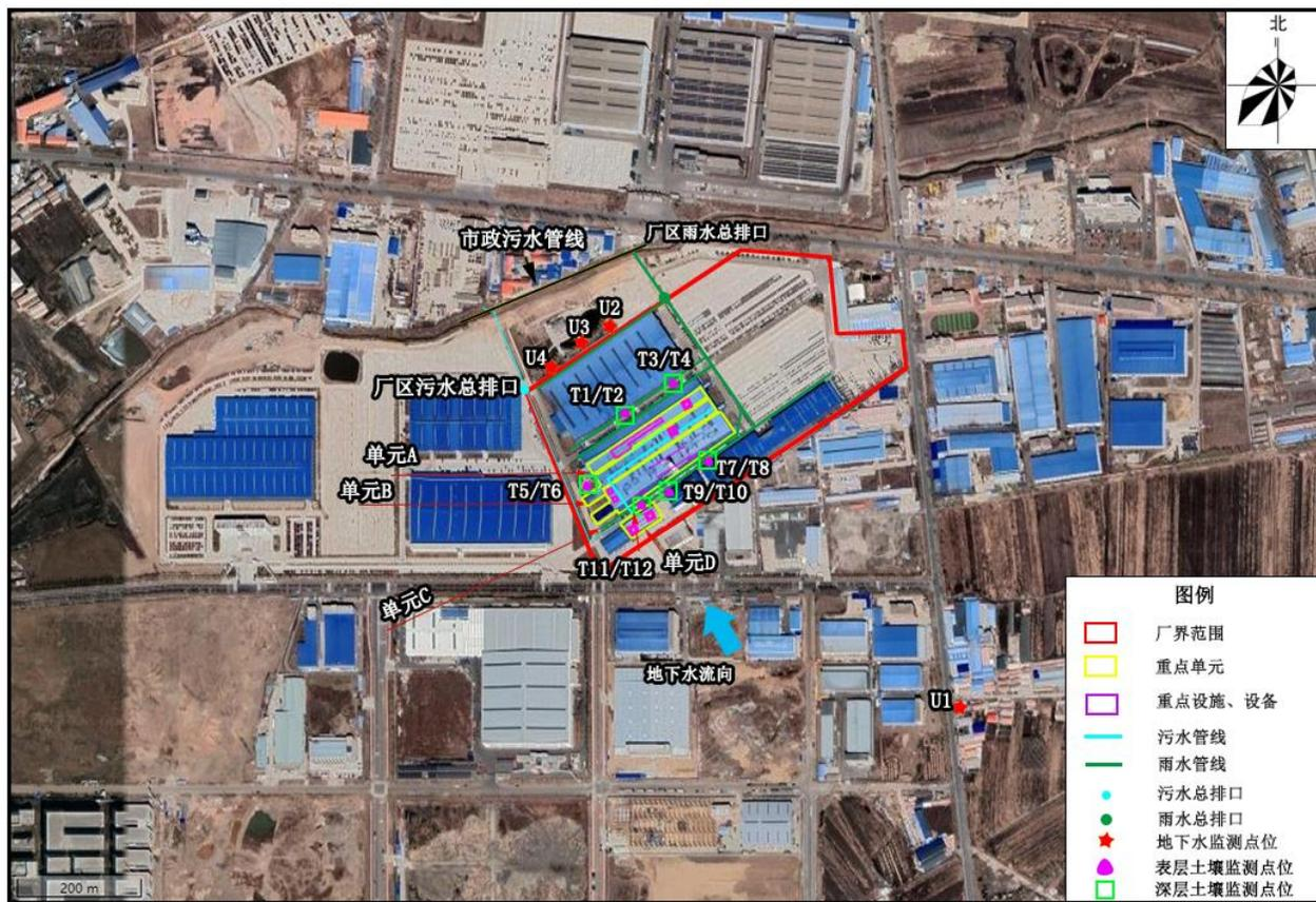
附图6-1 土壤及地下水监测点位布设平面图
